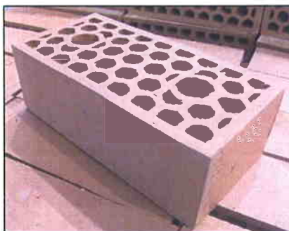
Imagen 1 Ladrillo cerámico perforado utilizado en la construcción de la pared de base
