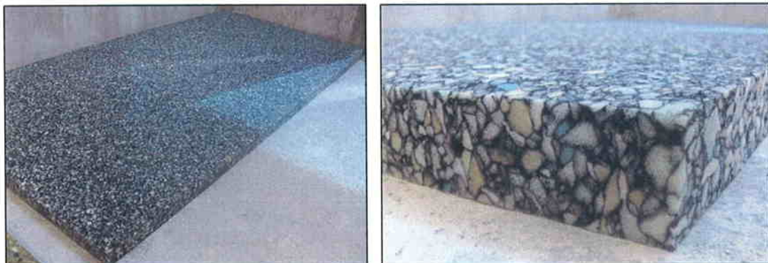
Imágenes 9 y 10 Panel AGLOPUR 80/40, de 40 mm de espesor y densidad 80 Kg/m 3
