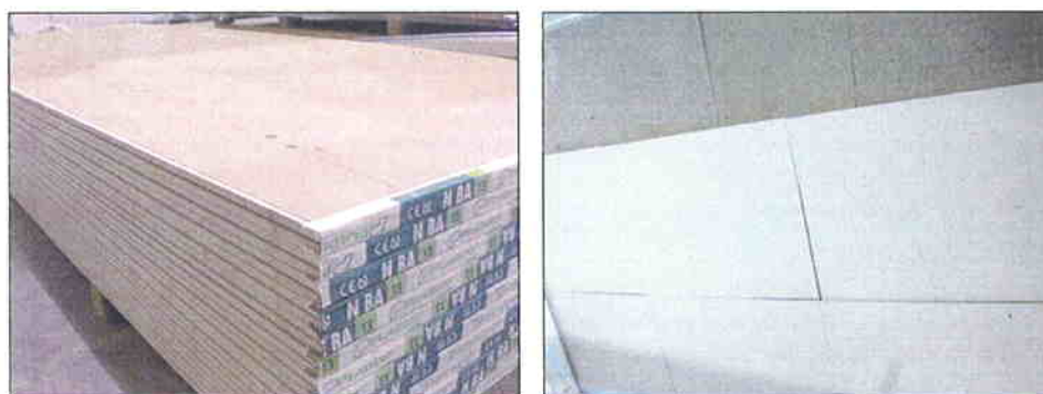
Imágenes 7 y 8 Placas de yeso laminado y su encolado sobre el panel
