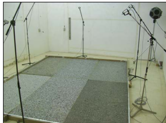
Imágenes 3 y 4. Detalle del encuentro de los paneles y muestra preparada para el ensayo
